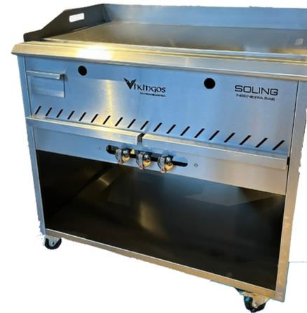
Cubierta superior fabricada en lámina de acero inoxidable Cal. 18 Ref. 304 y mueble en Cal. 20 Ref. 430. La plancha se compone de una placa de 1/2" en hierro pulido, y salpicaderos por 3 lados en acero inoxidable Cal. 14 Ref. 430 de 10 cm de altura y una canal recolectora de fluidos sobrantes, sistema de gas con 8 (Ocho) quemadores tipo flauta y venturis de 30Mil BTU/Hora c/u, 4 (Cuatro) válvulas de paso hincar de 1/4", Botones cromados.
