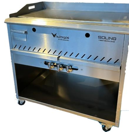
Cubierta superior fabricada en lámina de acero inoxidable Cal. 18 Ref. 304 y mueble en Cal. 20 Ref. 430. La plancha se compone de una placa de 1/2" en hierro pulido, y salpicaderos por 3 lados en acero inoxidable Cal. 14 Ref. 430 de 10 cm de altura y una canal recolectora de fluidos sobrantes, sistema de gas con 5 (Cinco) quemadores tipo flauta y venturis de 30Mil BTU/Hora c/u, 3 (Tres) válvulas de paso hincar de 1/4", Botones cromados.
