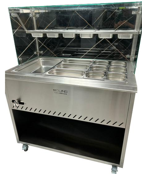
CCubierta superior y tanque fabricados en lamian de acero inoxidable Cal. 18 Ref. 304, mueble en Cal. 20 Ref. 430. Vidrio templado de 8 mm en parte superior con dilatadores en acero inoxidable, sistema de gas por medio de quemador tipo flauta y venturis de 1", válvula de paso hincar de 1/4", botones cromados. (Incluye azafates de acuerdo a lo solicitado), todo el acero en acabado satinado para brindar mejor apariencia del equipo.
