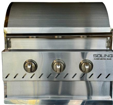
Cubierta superior fabricada en lámina de acero inoxidable Cal. 18 Ref. 304 y mueble en Cal. 20 Ref. 430. La parrilla se compone de ángulo de 1" y eje redondo de 3/8" en acero inoxidable, incluye difusores en acero inoxidable para distribuir el calor, sistema de gas con 3 (Tres) quemadores tipo flauta y venturis de 30Mil BTU/Hora c/u, 3 (Tres) válvulas de paso hincar de 1/4", Botones en acero de lujo.
