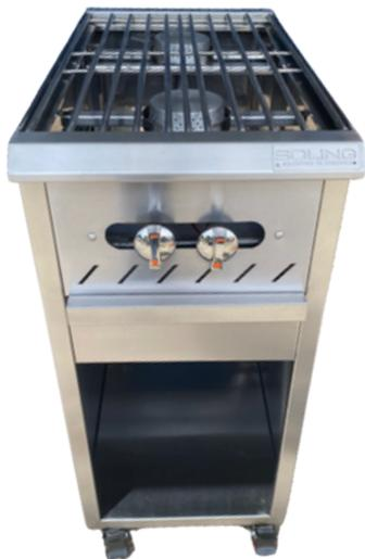
Cubierta superior fabricada en lámina de acero inoxidable Cal. 18 Ref. 304 y mueble en Cal. 20 Ref. 430. 2 (Dos) Parrillas en hierro fundido de 30x30 cm, 2 (Dos) válvulas de paso huncar de 1/4", Botones cromados, quemadores tipo hongo sellados en aluminio con consumo de 30Mil BTU/hora c/u, todo el acero en acabado satinado para brindar mejor apariencia del equipo.
