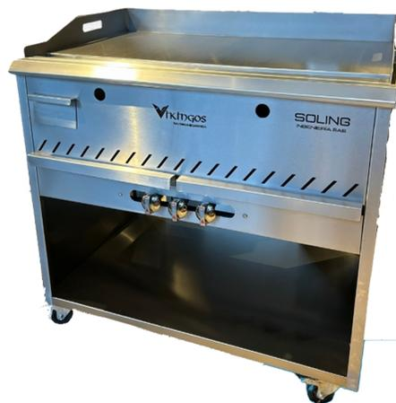
Cubierta superior fabricada en lámina de acero inoxidable Cal. 18 Ref. 304 y mueble en Cal. 20 Ref. 430. La plancha se compone de una placa de 5/8" en hierro pulido, y salpicaderos por 3 lados en acero inoxidable Cal. 14 Ref. 430 de 10 cm de altura y una canal recolectora de fluidos sobrantes, sistema de gas con 10 (Diez) quemadores tipo flauta y venturis de 30Mil BTU/Hora c/u, 5 (Cinco) válvulas de paso hincar de 1/4", Botones cromados.
