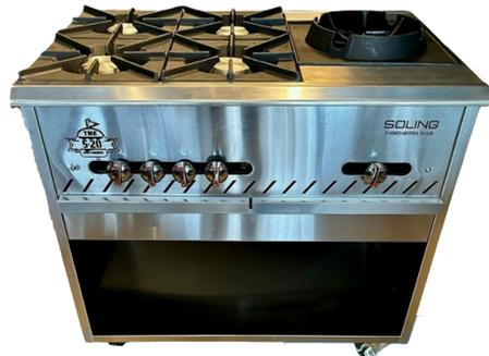
Cubierta superior fabricada en lámina de acero inoxidable Cal. 18 Ref. 304 y mueble en Cal. 20 Ref. 430. 4 (Cuatro) Parrillas en hierro fundido de 30x30 cm y 1 (una) Parrilla en hierro fundido de 40x40 cm wok , 4 (Cuatro) válvulas de paso huncar de 1/4", Botones cromados, quemadores tipo hongo sellados en aluminio con consumo de 30Mil BTU/hora c/u, quemador de corona con fistos de soplete para wok, todo el acero en acabado satinado para brindar mejor apariencia del equipo.
