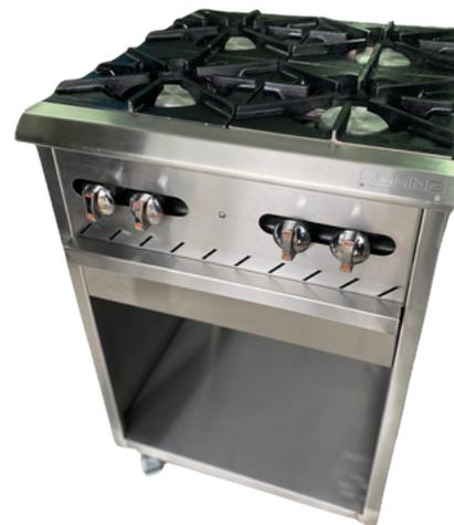
Cubierta superior fabricada en lámina de acero inoxidable Cal. 18 Ref. 304 y mueble en Cal. 20 Ref. 430. 4 (Cuatro) Parrillas en hierro fundido de 30x30 cm, 4 (Cuatro) válvulas de paso huncar de 1/4", Botones cromados, quemadores tipo hongo sellados en aluminio con consumo de 30Mil BTU/hora c/u, todo el acero en acabado satinado para brindar mejor apariencia del equipo.
