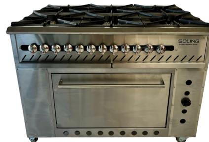
Cubierta superior fabricada en lámina de acero inoxidable Cal. 18 Ref. 304 y mueble en Cal. 20 Ref. 430. 8 (Ocho) Parrillas en hierro fundido de 30x30 cm, 8 (Ocho) válvulas de paso huncar de 1/4", Botones cromados, quemadores tipo hongo sellados en aluminio con consumo de 30Mil BTU/hora c/u, todo el acero en acabado satinado para brindar mejor apariencia del equipo.
