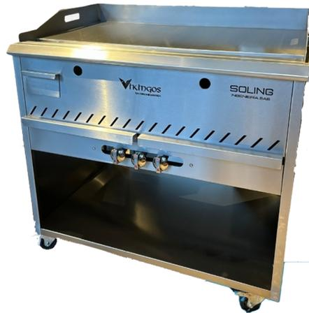
Cubierta superior fabricada en lámina de acero inoxidable Cal. 18 Ref. 304 y mueble en Cal. 20 Ref. 430. La plancha se compone de una placa de 3/8" en hierro pulido, y salpicaderos por 3 lados en acero inoxidable Cal. 14 Ref. 430 de 10 cm de altura y una canal recolectora de fluidos sobrantes, sistema de gas con 4 (Cuatro) quemadores tipo flauta y venturis de 30Mil BTU/Hora c/u, 2 (Dos) válvulas de paso hincar de 1/4", Botones cromados.
