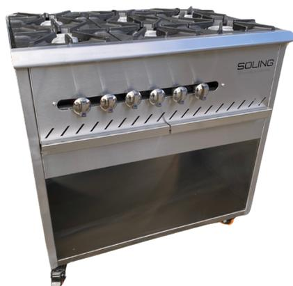
Cubierta superior fabricada en lámina de acero inoxidable Cal. 18 Ref. 304 y mueble en Cal. 20 Ref. 430. 6 (Seis) Parrillas en hierro fundido de 30x30 cm, 6 (Seis) válvulas de paso huncar de 1/4", Botones cromados, quemadores tipo hongo sellados en aluminio con consumo de 30Mil BTU/hora c/u, todo el acero en acabado satinado para brindar mejor apariencia del equipo.
